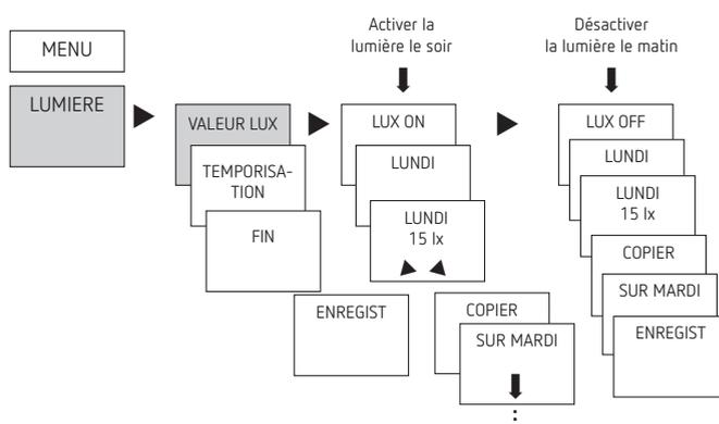
① L'appareil est pré-réglé sur une valeur de 15 lx pour le seuil d'enclenchement et de déclenchement
