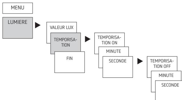
① La temporisation d'enclenchement/déclenchement de **1 min.** est prédéfinie pour éviter les commutations accidentelles notamment dues à l'éclair ou aux phares des voitures. Pendant que la temporisation s'écoule, l'état du canal ON/OFF clignote.
